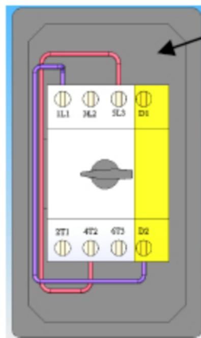
NOTA : dans le cas du remplacement d'un ancien disjoncteur par un nouveau cadenassable, la serrure n'est plus raccordée, il faut supprimer les fils noirs du contact 0-1 sur le schéma.
