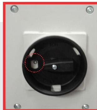
En cas d'arrêt involontaire du moteur, veuillez attendre le réarmement du disjoncteur (1 à 2 min) et tournez le bouton de la position T à la position O, puis à la position I.
